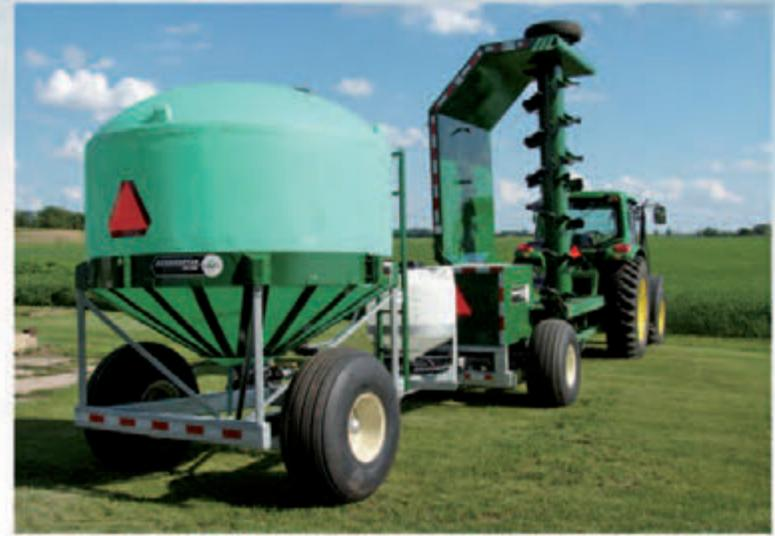
エアロマスター ウォータートレーラーは、エアロマスター堆肥攪拌機に、処理効率と製品品質を最大限にするために必要な水分と微生物植菌を提供します。独自の水分および植菌供給システムは、個々の粒子に適量の水を加え、バイルの水分量を最適に保つ手助けをします。
